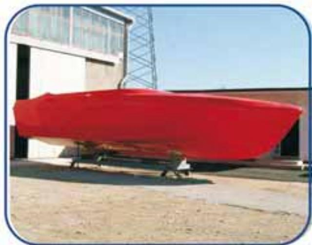
UNICA 42 nasce da un progetto della VICTORY DESIGN. La volontà del costruttore era quella di realizzare una barca nel solco della tradizione dei motoscafi d'altura americani. La sapiente matita di BRUNELLO ACAMPORA ha realizzato uno scafo dalle linee essenziali la cui carena disegnata con una "V" profonda evidenzia doti di stabilità e fluidità che consentono elevate performance marine misurabili soprattutto in condizioni di mare formato e consumi ridotti.
